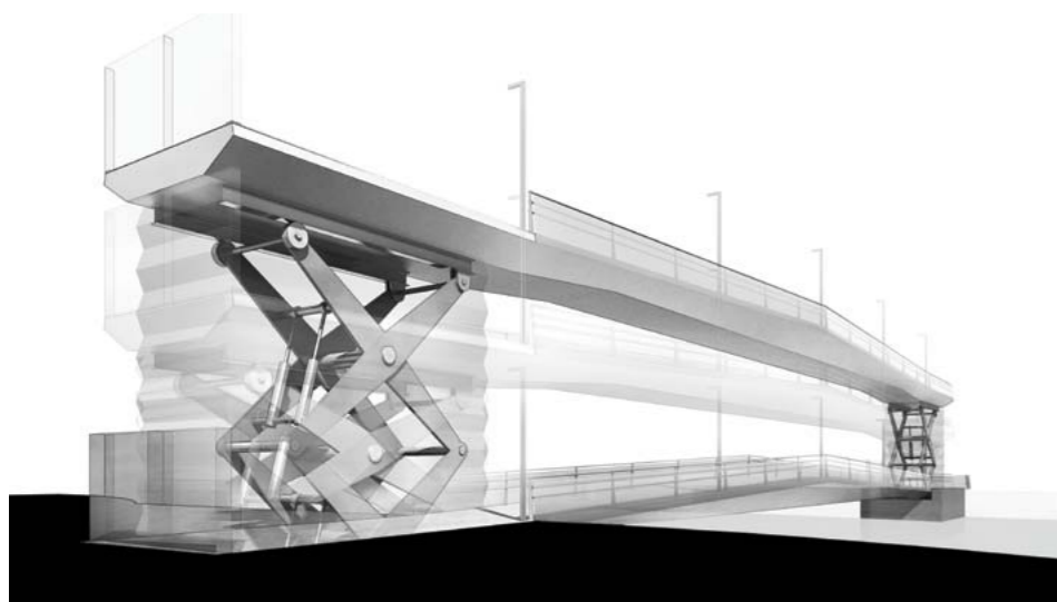
Abb.: Hebevorgang der Brücke
