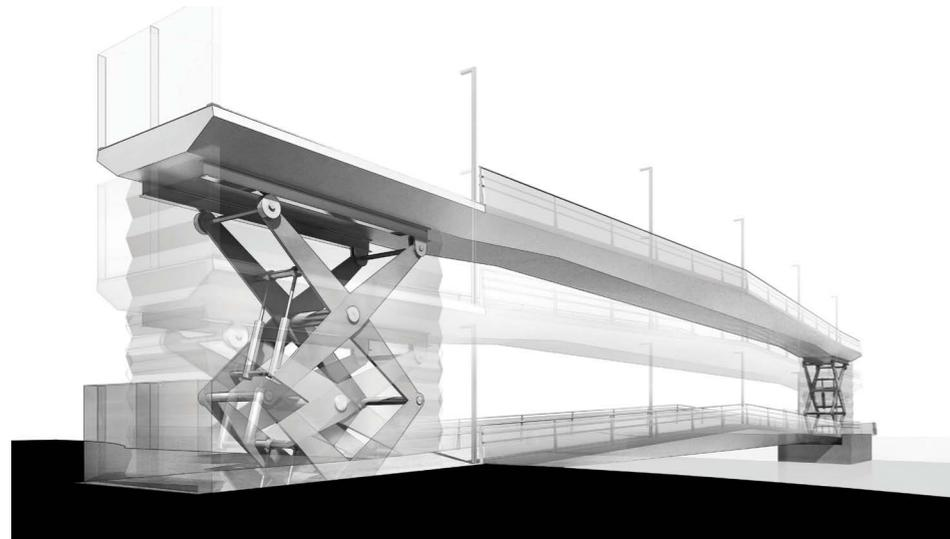
Abb.: Hebevorgang der Brücke
