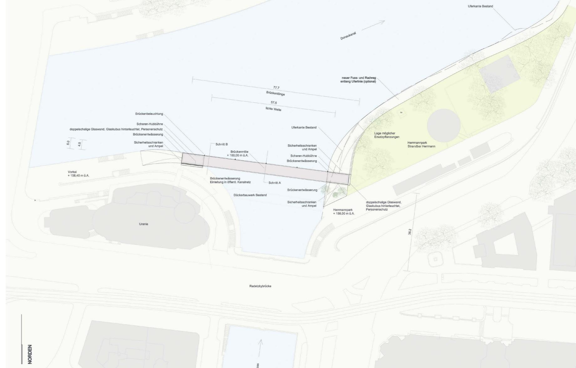
Die Kaimauer im Bereich Urania wird geringfügig nach außen gezogen. Dadurch entsteht ein leicht veränderter Verlauf der historischen Steinmauer bis zum nordwestlichen Auflagerpunkt der Brücke. Die bestehenden Natursteinblöcke (Steinmetzarbeiten) sollen abgebaut und nach Möglichkeit wieder verwendet werden. Direkt unter der Brücke (Auflagerbereich) wird die Kaimauer durch ein neues Element in Form einer Weißbetonwand (Außenansicht der Maschinengrube und des Auflagers) betont.
